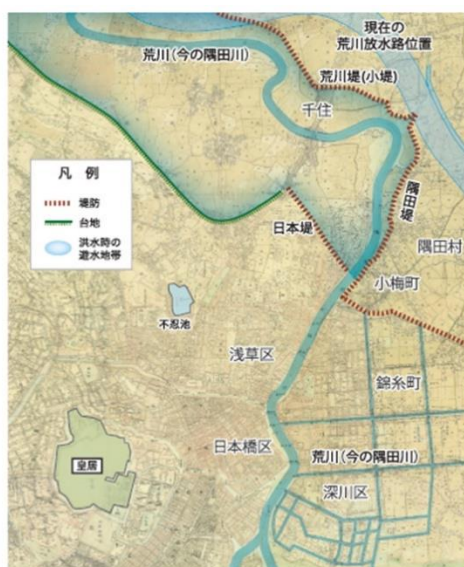
（図2）荒川放水路開削工事前の堤の様子（荒川下流河川事務所編『荒川放水路変遷誌』（2011）より）
